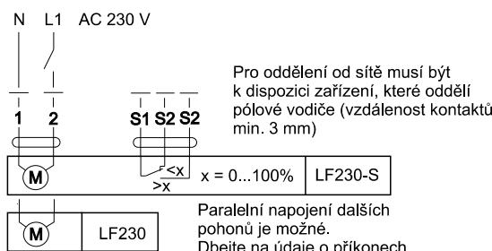
Schéma zapojení uvedená v katalogu jsou pouze orientační. Vždy je nutno upřesnit schéma zapojení uvedené na výrobku.
